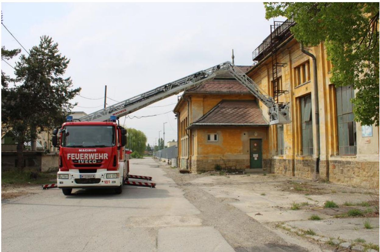
Bild 2: Gelenkdrehleiter Magirus Baureihe CS GLT mit teleskopierbaren Gelenkteil. Eine maximale Rettungshöhe von 30m wird mit dieser Bauausführung wieder erreicht, aber auf Kosten der Ausladung. Aufgrund des hohen Gewichtes des Gelenkteils sind die erreichbaren Ausladungswerte geringer als beim Vorgängermodell.
