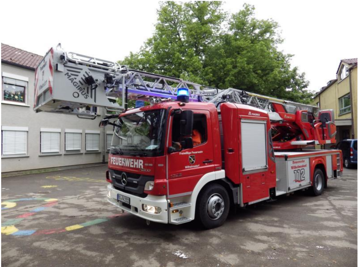
Bild 2: Gelenkdrehleiter Magirus Baureihe CS GLT mit teleskopierbaren Gelenkteil. Eine maximale Rettungshöhe von 30m wird mit dieser Bauausführung wieder erreicht, aber auf Kosten der Ausladung. Aufgrund des hohen Gewichtes des Gelenkteils sind die erreichbaren Ausladungswerte geringer als beim Vorgängermodell.
